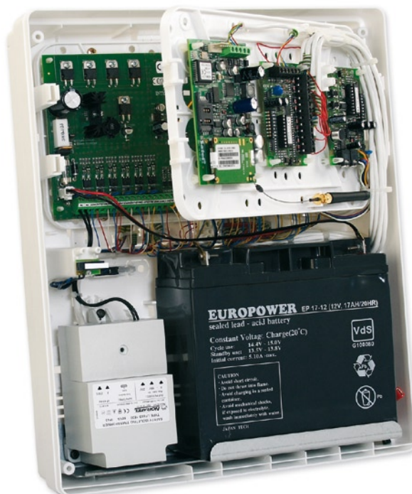
Przykładowa konfiguracja sprzętu do obudowy OPU-3 P
